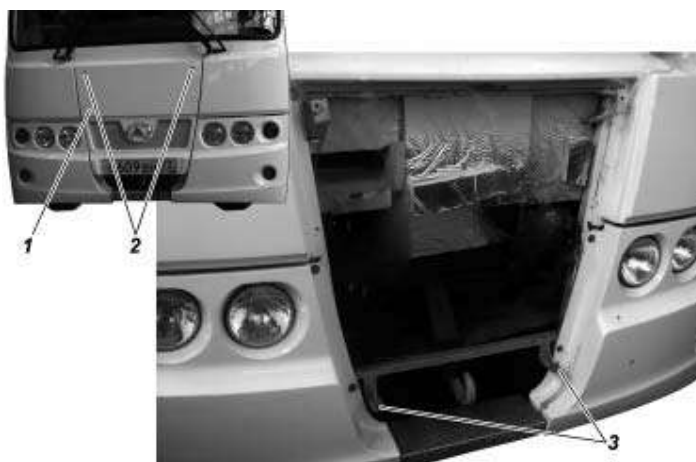
Рис. 3.17. Передний технологический люк: 1 -люк; 2 -болты крепления люка; 3 -установочные шпильки
