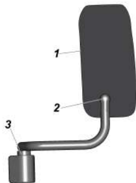
Рис. 3.19. Наружное зеркало: 1 -зеркало; 2 -шарнир; 3 -рычаг
