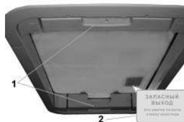
Рис. 3.30. Люк крыши: 1 -ручки; 2 -инструкционная табличка
