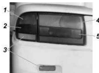
Рис. 5.21. Задние фонари: 1 - задний габаритный фонарь и фонарь стоп-сигнала; 2 - указатель поворота; 3 - световозвращатель; 4 - задний противотуманный фонарь; 5 - фонарь заднего хода
