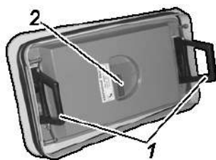
Рис. 3.29. Люк крыши: 1 -ручки; 2 -аварийная ручка
