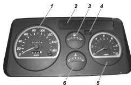
Рис. 3.9. Комбинация приборов: 1 -спидометр, имеет два счетчика пройденного пути: суммарный и суточный, установку на ноль показаний суточного счетчика производите нажатием на кнопку сброса; 2 -блок контрольных ламп; 3 -указатель уровня топлива; 4 -лампа аварийной сигнализации; 5 -манометр для контроля давления воздуха в пневмосистеме дверей; 6 -указатель температуры охлаждающей жидкости, при положении стрелки указателя в красной зоне, работа двигателя не допускается
