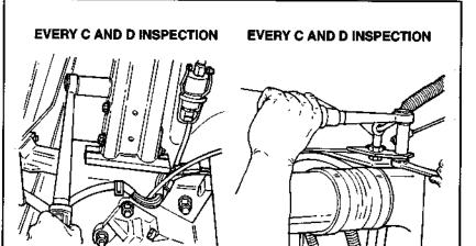
**TORQUING CHARGE AIR COOLER MOUNTS**
