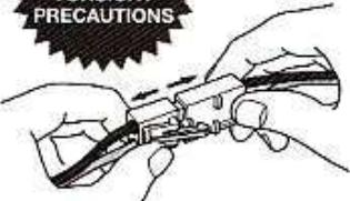
走行させない時は必ず走行用バッテリーのコネクターをはずしてください。走行用バッテリーをつないだままでおくと、車が暴走することがあります。走らせないとときは、必ず走行用バッテリーのコネクターを抜いておきます。
