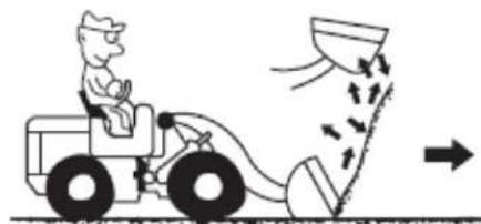
Pone la palanca de mando a la posición de elevación, lo opera a inclinar atrás la cuchara por 2-3 veces para llenar los materiales
