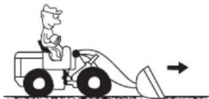
Deja el cuchara mantener condición horizontal con el suelo, y se inclina hacia adelante un poco.
