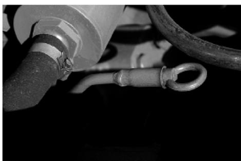
**Fig. 5-11 Posición de regla de aceite de motor**
