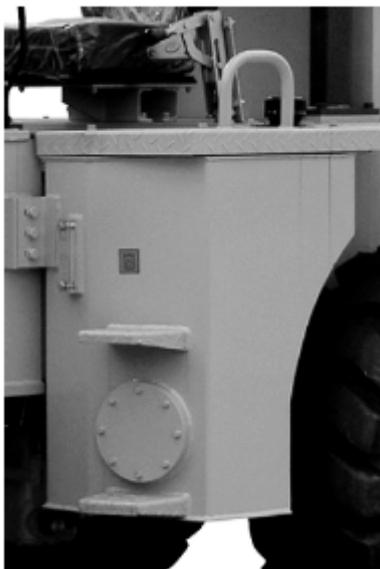
**Fig. 5-8 Posición de depósito hidráulico**
